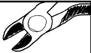
ДЕРЖА ЗАТОЧЕННОЙ СТОРОНОЙ ВНИЗ, ПОДНЕСИТЕ КУСАЧКИ К ВЫВОДУ, ПРИЦЕЛИВШИСЬ ЧУТЬ ВЫШЕ БУТОРКА ПРИПОЯ. СОЖМИТЕ РУЧКИ И РЕЖУЩИЕ КРОМКИ С ЩЕЛЧКОМ ПЕРЕРЕЖУТ НОЖКУ...
