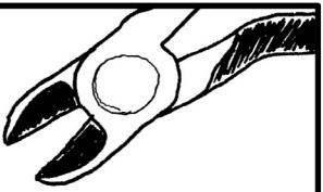
ДЕРЖА ЗАТОЧЕННОЙ СТОРОНОЙ ВНИЗ, ПОДНЕСИТЕ КУСАЧКИ К ВЫВОДУ, ПРИЦЕЛИВШИСЬ ЧУТЬ ВЫШЕ БУТОРКА ПРИПОЯ. СОЖМИТЕ РУЧКИ И РЕЖУЩИЕ КРОМКИ С ЩЕЛЧКОМ ПЕРЕРЕЖУТ НОЖКУ...
